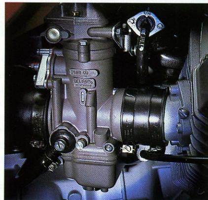
Zwei 40-mm-Rundschiebervergaser mit Beschleunigungspumpe.
